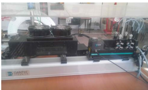
Fig.1. Aparatura folosită în cadrul determinărilor experimentale: a) echipament laser, b) echipament metoda termodinamică.
