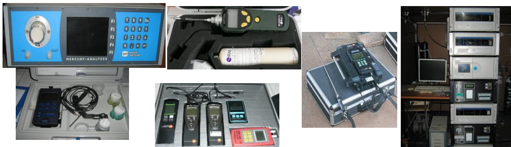
Fig. 1. Masurarea concentratie de mercur in gaze de ardere, Masurare COV prin fotodetectie, Masurare pH, Masurare parametri termodinamici (temp, presiuni, debite), sistem complex de analiză a caității aerului
