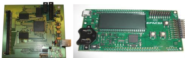
Fig.1. Aparatura folosita in cadrul determinarilor experimentale: a) Modul de dezvoltare pentru domeniul telecom. Digitale b) EnergyMicro EFM32G890_STK
