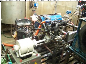
Fig.1. Stand încercare motor cu ardere internă utilizat în cadrul atelierului tematic 22-P1
