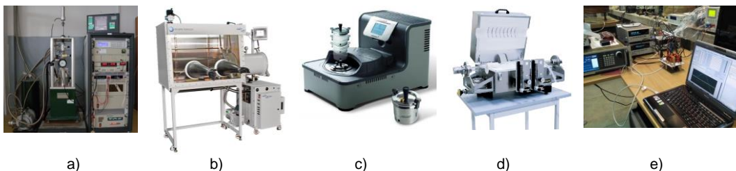
Fig.1. Aparatura folosită în cadrul determinărilor experimentale: a) Sistem criogenic "7Testa Mini Cryogen Free measurement System (7T mCFMS)", b) Boxă cu mânuși cu purificator de gaz, "PureLab HE 2" c) Moară planetară de măcinare cu bile de mare energie, "Pulverisette 7 premium line" d) Cuptor de tratament termic cu tub orizontal RS80/500/13 e) Sistem computerizat de caracterizare galvanomagnetică a straturilor subțiri – sala CP 28 – Sursa de putere programabilă BOP 100-10 MG, Nanovoltmetru Keithely 2182A, Sursa de curent programabilă Keithely 6221.
