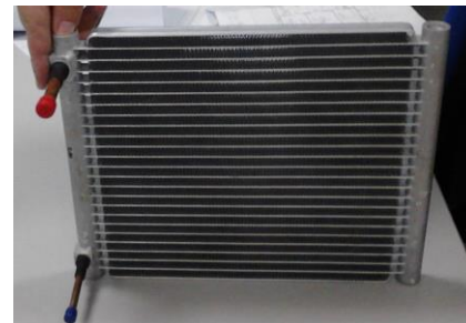
Fig.1. Aparatura folosită în cadrul determinărilor experimentale: a) instalație frigorifică cu comprimare de vapori, b) condensator cu microcanale.
