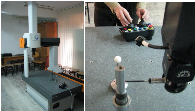
Fig.1. Aparatura folosita in cadrul determinarilor experimentale: Mașina de măsurat în coordonat Metris C3V 10.7.7
