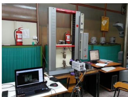
a) Mașina de încercat Zwick și camera Photron
