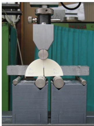
Fig.2. Încercarea epruvetelor ASCB din spume poliuretanică în modul mixt din cadrul atelierului AT 10_S.
