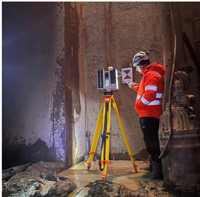
Fig.4. Scanare realizată în interiorul vanei
