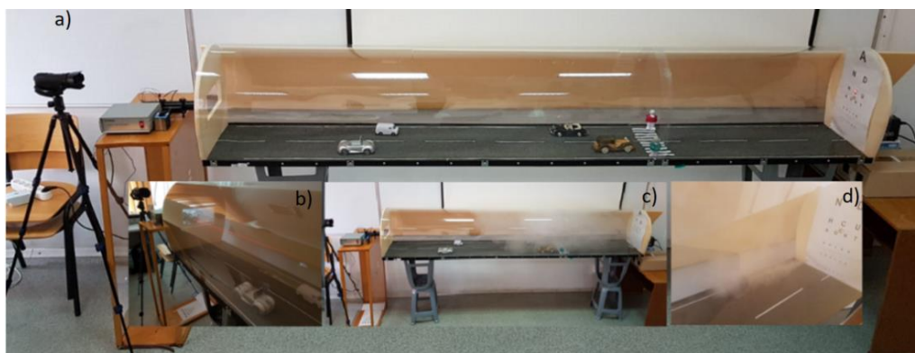
Fig. 12 Sistemul experimental utilizat pentru estimarea vizibilității pe timp de ceață.
