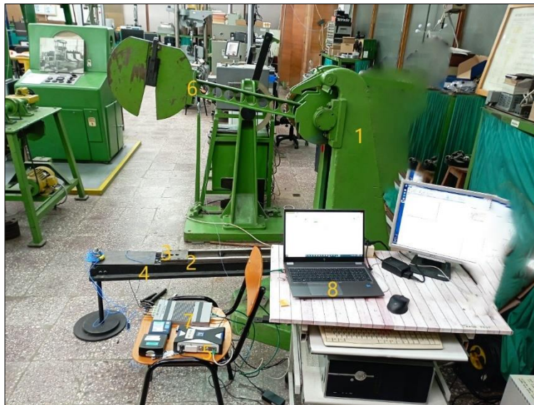
Fig. 18 Pendul instrumentat pentru încercări distructive dinamice
