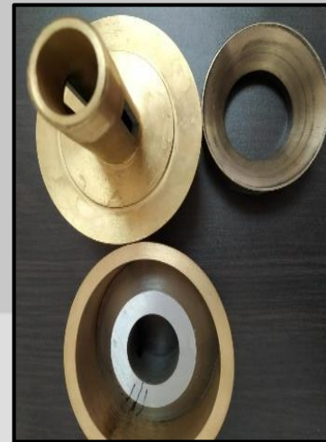
Sistemul de franare a rotorului pentru realizarea diferitelor regimuri de curgere
